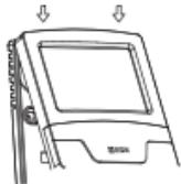
4、将电源排线与主板连接好，前壳成30°角挂在后壳上面的两个挂钩内，顺时针旋转到位，用力按压上壳两个角，卡住上壳，安装完毕。
