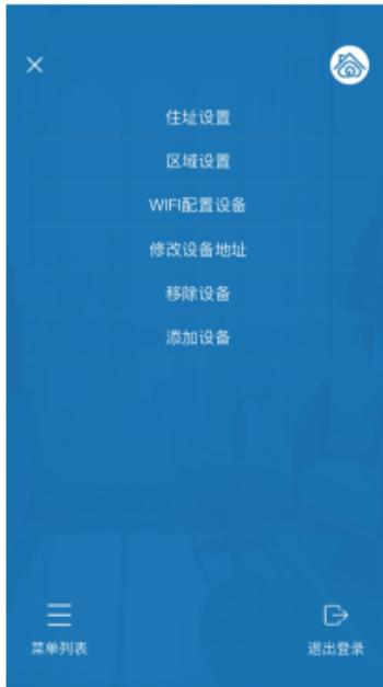
3、WIFI配置设备：输入所联接WIFI名称和密码，配置WIFI温控器时点击“添加设备”，以便顺利配置温控器。WIFI配置只能和2.4G频段匹配，并打开手机蓝牙。
